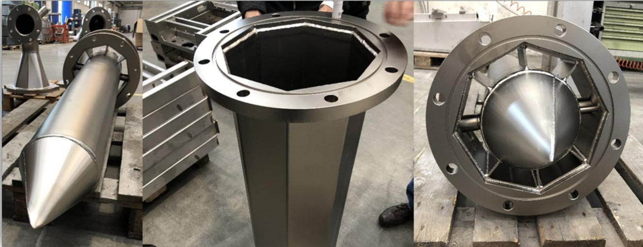
Figura 5. Alcune fasi della costruzione della unità modulare del ‘*Sono-Heat-Exchanger*’ – ‘*Olive Sound*’ costruita per i test di ottimizzazione.
