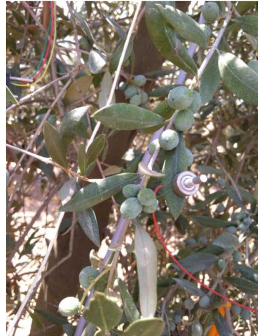
La misura del turgore fogliare viene rilevata dal sensore di pressione sotto una costante pressione esterna  $P_{clamp}$  (fino a 250 kPa)
